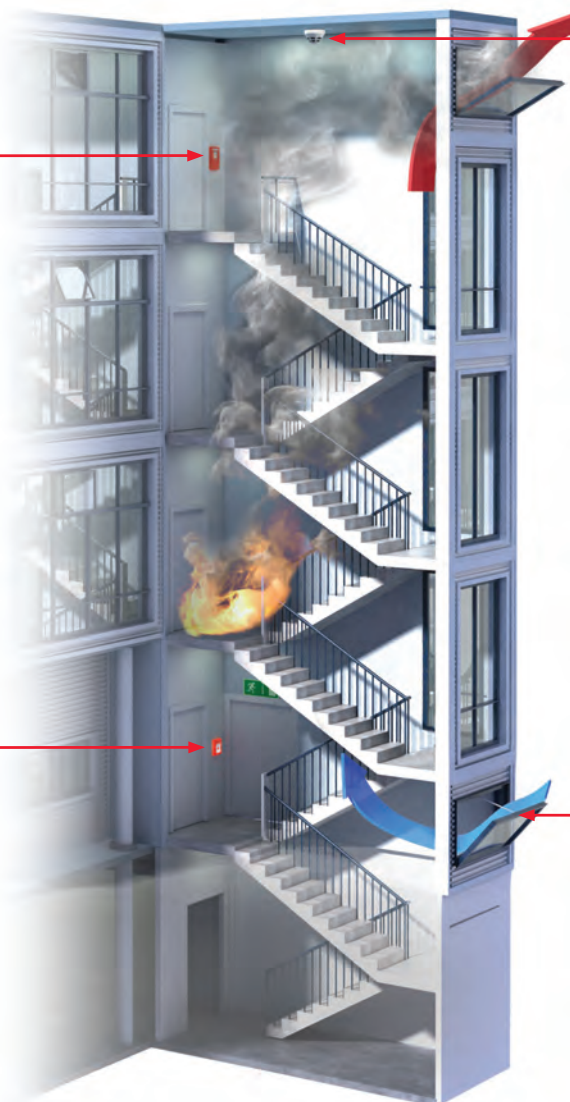
Элементы управления Тип: RT 45 / RT 45 - LT Кнопка со встроенной функцией вентиляции (по выбору) Область применения: Лестничные клетки в зданиях
